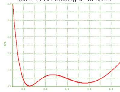
CaF 2 IR AR Coating 3 μm-5 μm
